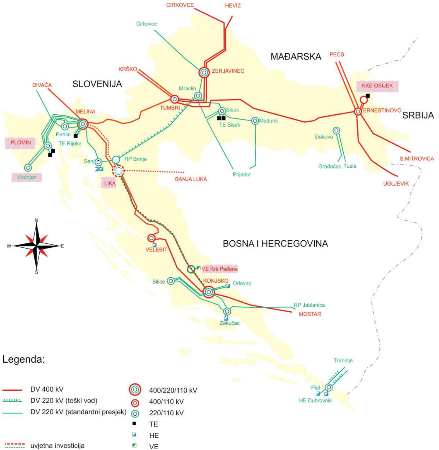
Slika 4.10. Konfiguracija 400 kV i 220 kV mreže krajem 2025. godine
