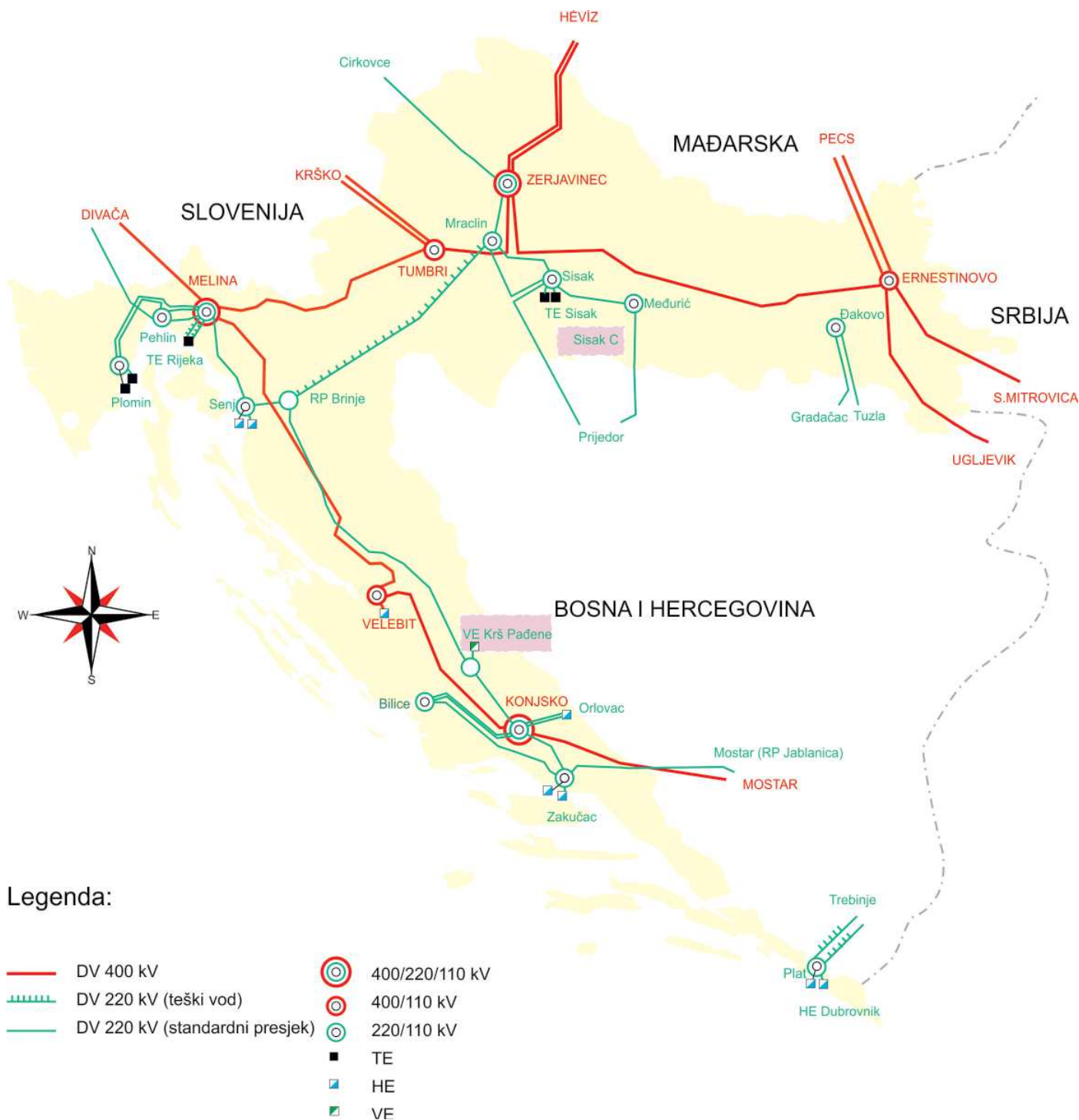
Slika 4.1. Konfiguracija 400 kV i 220 kV mreže početkom 2019. godine
